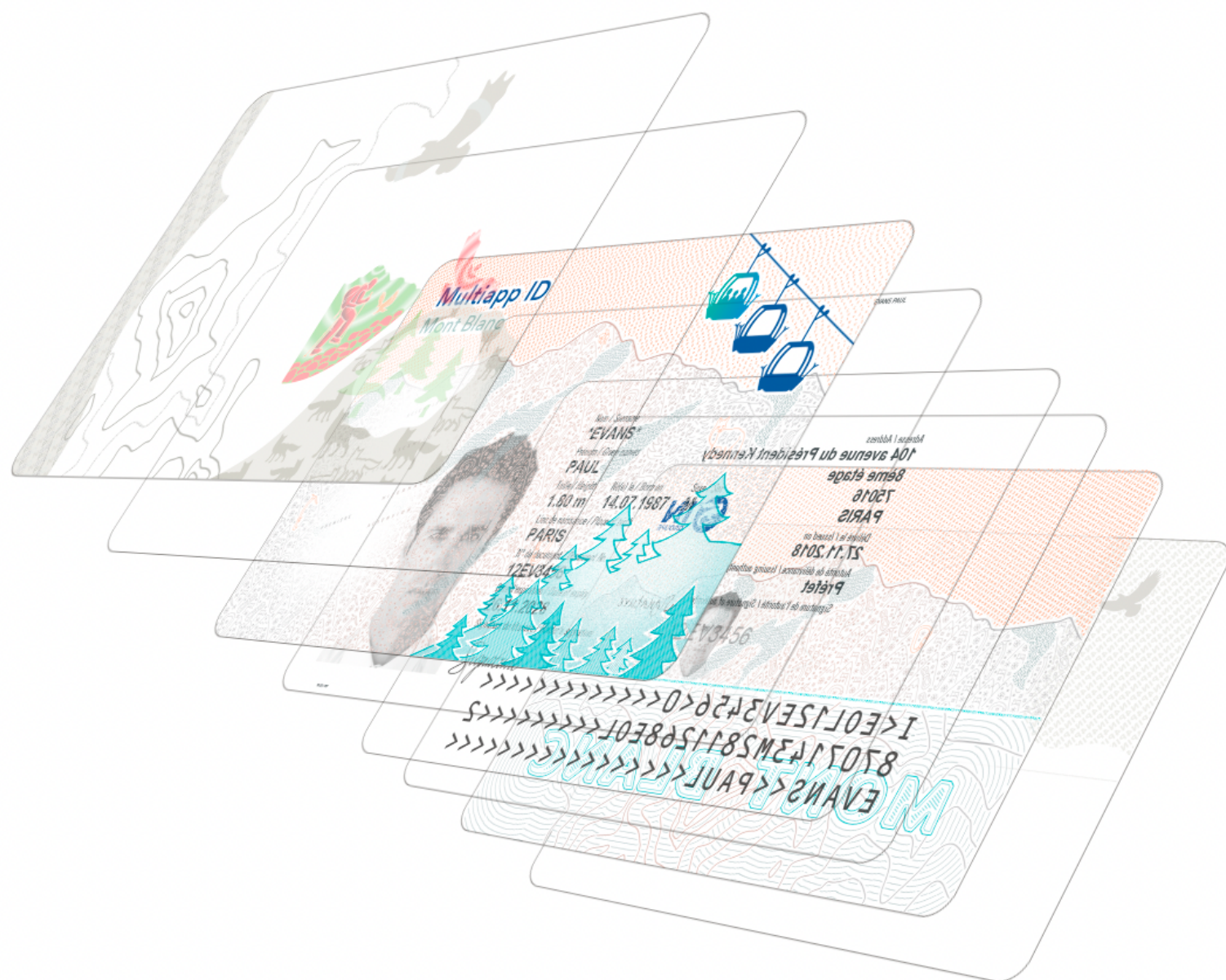
Vue décomposée d'une carte polycarbonate
